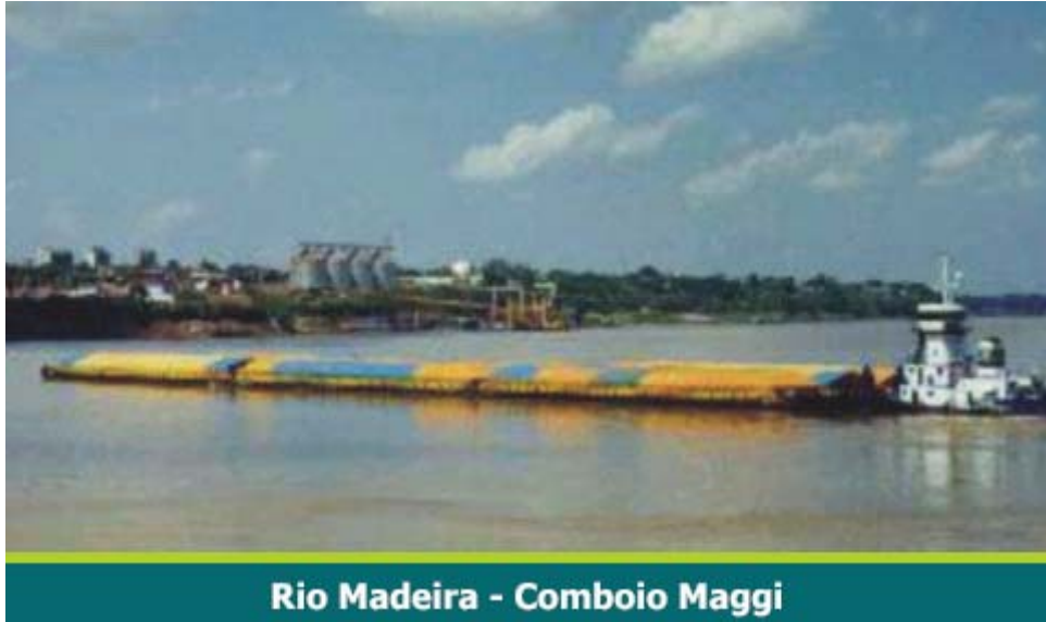
FIG. 3.6 – Transporte da soja entre Porto Velho (RO) e Itacoatiara (AM) = 1.056 Km Comboio com 12/16 chatas Fonte: ANTT
