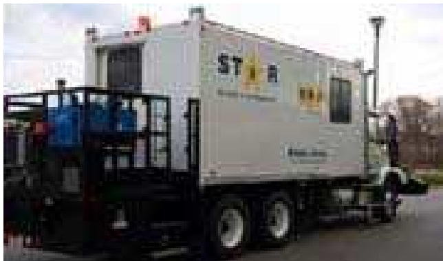
Figura 4 - Veículo de Avaliação de Via
