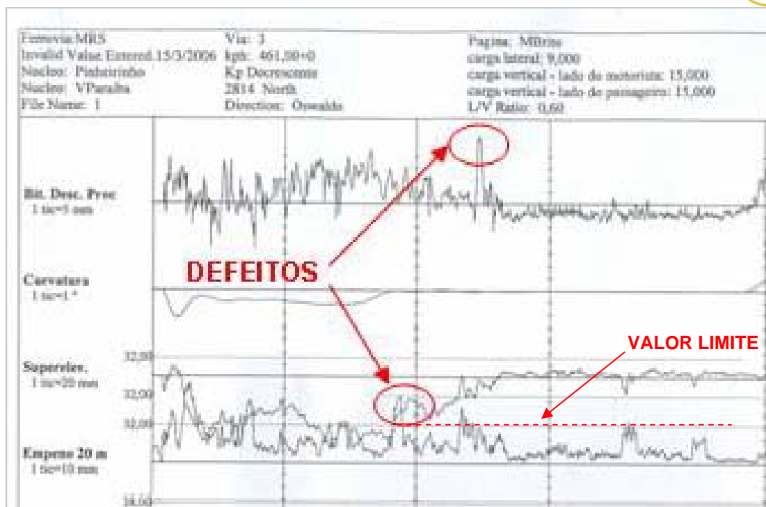
Figura 7 – Destaque dos defeitos e do valor limite de empeno
