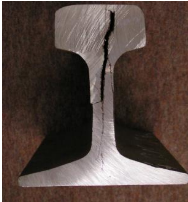
Fig. 2.5 - Trinca transversal Fonte: Ch. Vidon 2005
