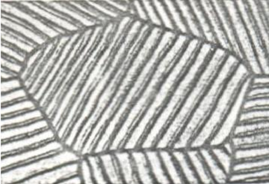
Fig. 2.9 - Estrutura Perlítica Fonte: Ch. Vidon 2006
