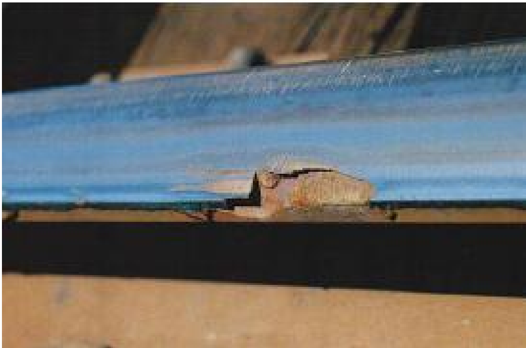
Fig. 3.5 - Shelling em estágio avançado Fonte: Marich 2005
