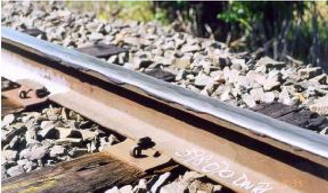
Figure 3.11 - Deformação plástica Fonte: Marich 2005
