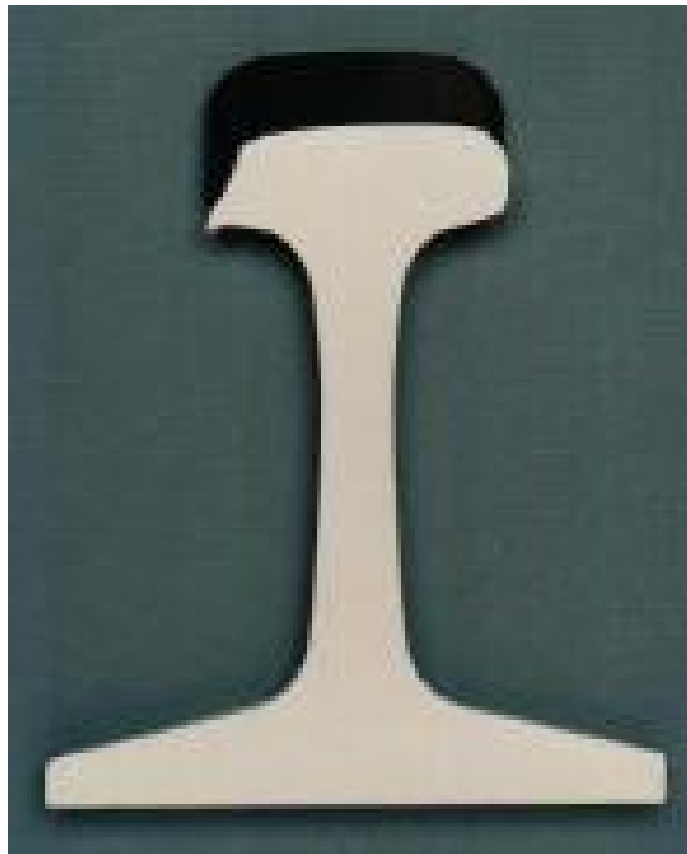
Fig. 3.8 - trilho com desgaste Fonte: Marich - 2005
