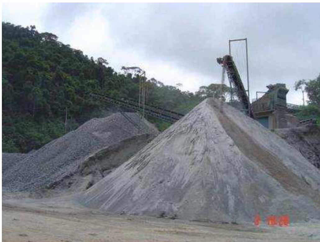
Figura 4: Vista do depósito de pedra britada para lastro e pó-de-pedra
