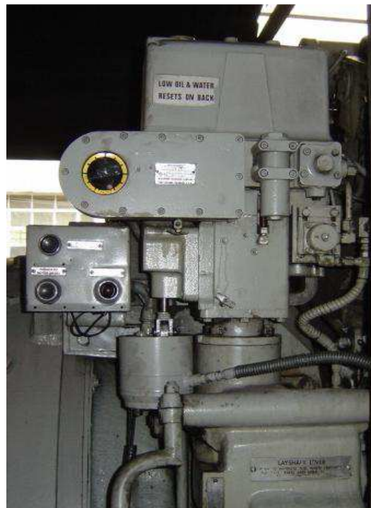
Figura 5 – Governador do motor diesel. Fonte: DORNELAS (2012)
