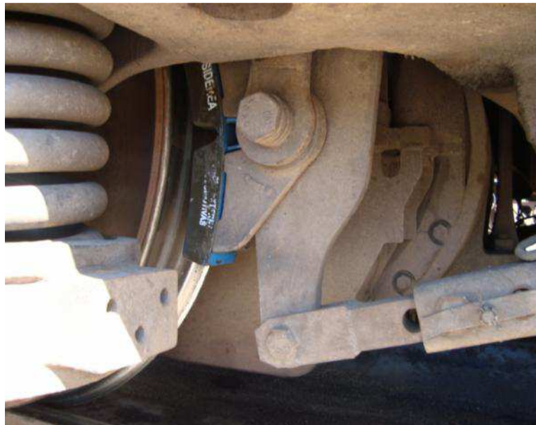
Figura 10 – Contato da sapata de freio com a roda da locomotiva. Fonte: DORNELAS (2012)
