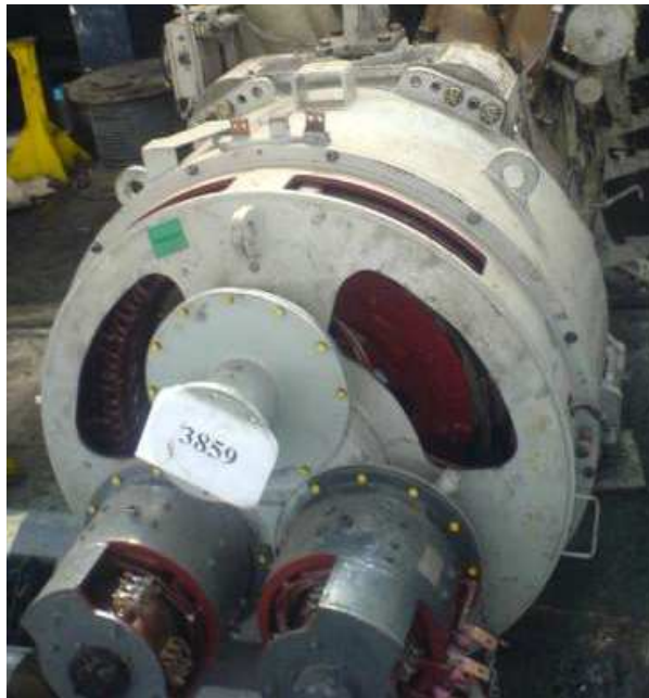
Figura 4 – Alternador. Fonte: OLIVEIRA (2012)
