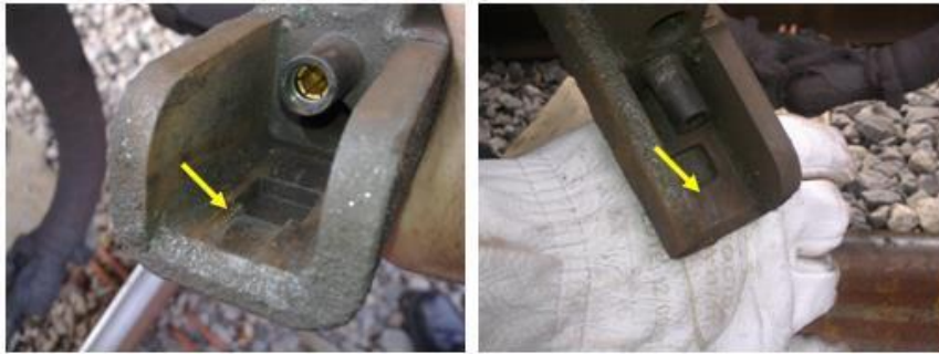
Figura 7: Conectores avariados por desgaste prematuro e trinca
