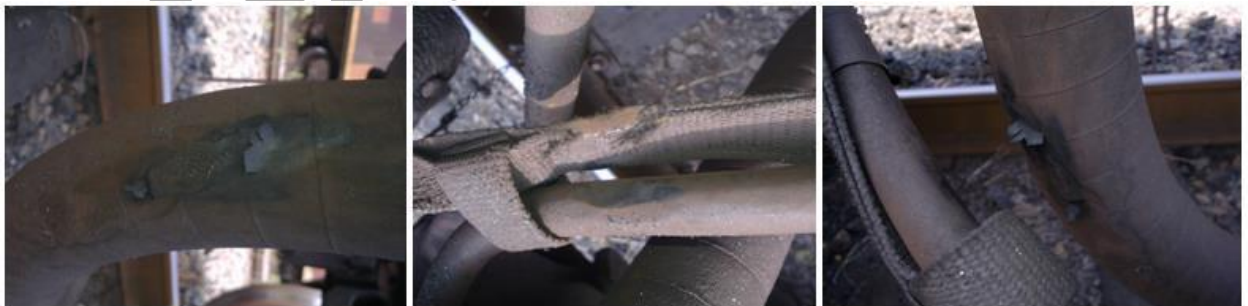
Figura 18 – Desgaste nas mangueiras e cabos elétricos
