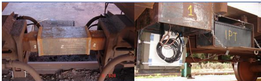
Figura 4: Hastes instrumentadas e registrador de dados
