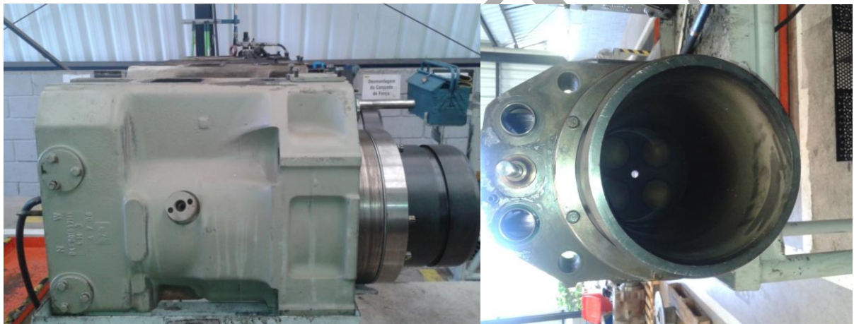
Figura 2: Conjunto de força composto por jaqueta, camisa e cabeçote. Fonte: Coordenação de Recuperação de Componentes de Locomotivas MRS.
