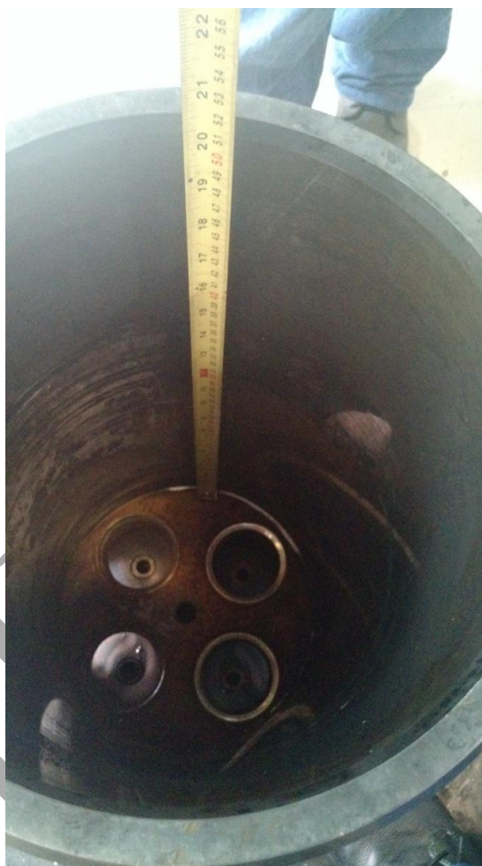
Figura 6: Vista interna da camisa do cilindro.
