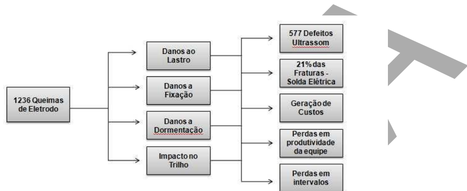
Figura 4: Impacto dos defeitos em solda
